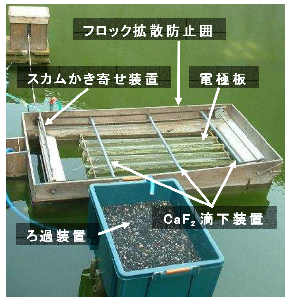
写真-1 電解システム
