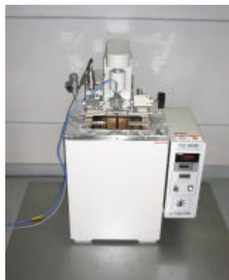
写真 - 1 硝酸塩加熱装置(ソルトバス)
