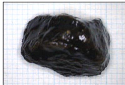
写真-4 粗骨材(被膜後)
