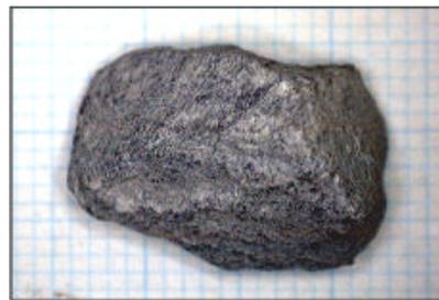
写真-3 粗骨材(被膜前)
