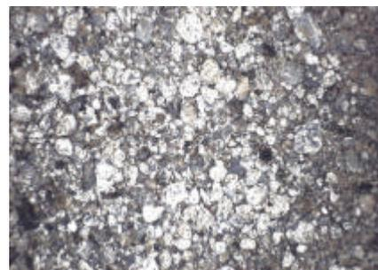
写真-8 細骨材(反応後)
