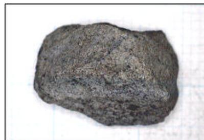
写真-5 粗骨材(反応後)
