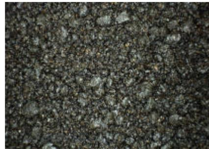
写真-7 細骨材(被膜後)
