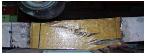
写真 3 所定荷重載荷後破壊状況(1)
