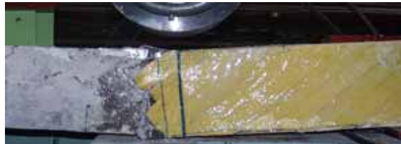
写真 4 所定荷重載荷後破壊状況(2)
