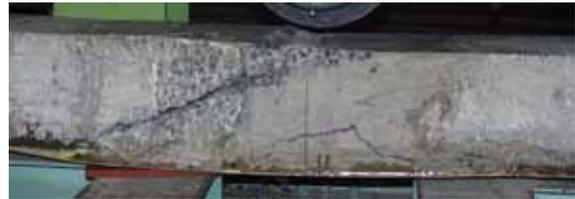
写真-2 破壊発生時 (No. 1)
