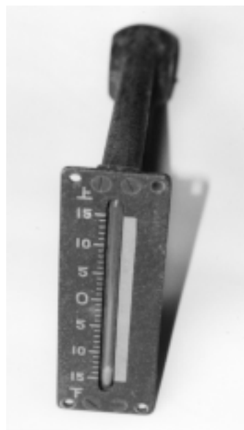
写真3 縦斜計・表示盤
