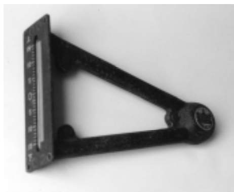
写真4 縦斜計・全体
