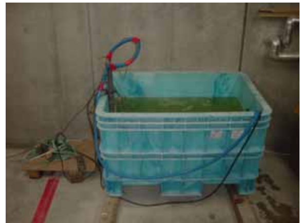
写真1 温水養生槽の外観
