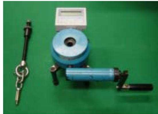
写真-2 簡易型引張り試験器
