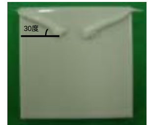
写真 2 シーリング 貼付状況
