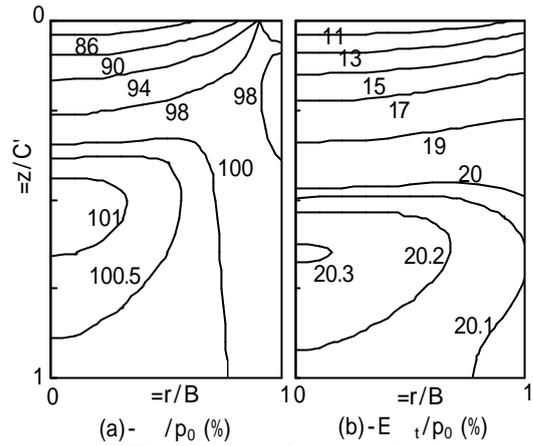
図-6 応力-ひずみのコンター例 (  $\alpha=0.2, \beta=4, \gamma=0.5, q_0=0$  )
