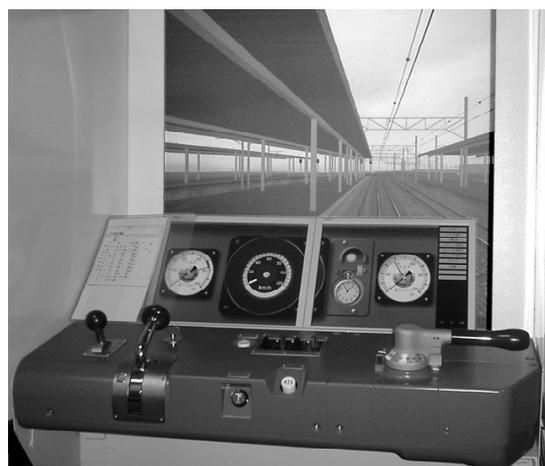
図1 列車運転シミュレータ
