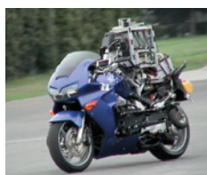
図1 構築したライダーロボット
