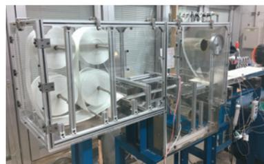
図1 引抜成形装置
