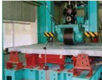
図-1 走行振動疲労試験機
