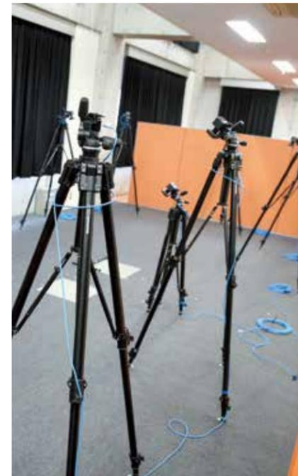
三次元人体動作計測・筋骨格モデル動作解析システム
