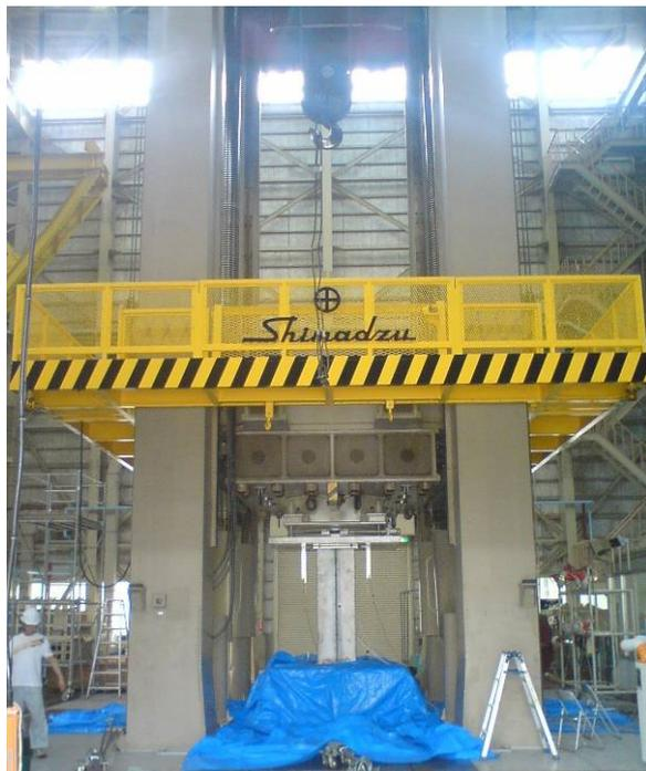
写真1 実験風景 (30MN 試験機)
