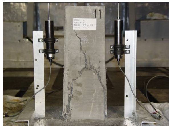
写真 5 最終破壊形状(試験体 : 0-R-U)
