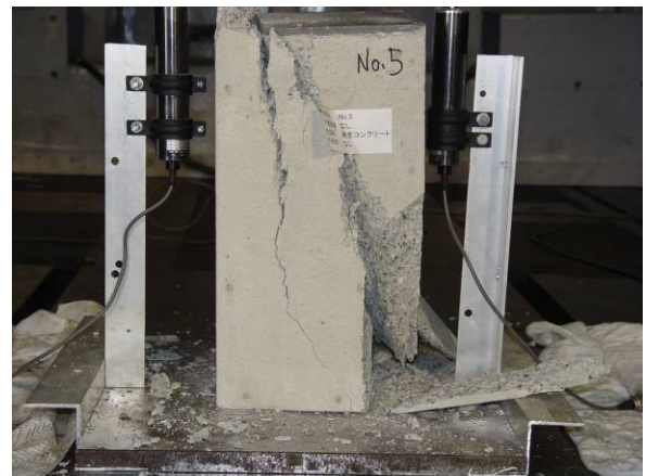
写真3 最終破壊形状(試験体: 0-R-02)
