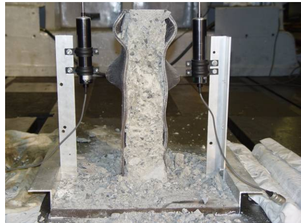
写真 6 最終破壊形状(試験体 : S-P-02)
