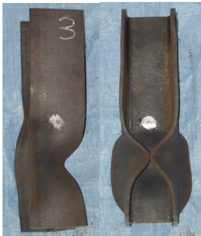
写真2 最終破壊形状(試験体: S-0-0)
