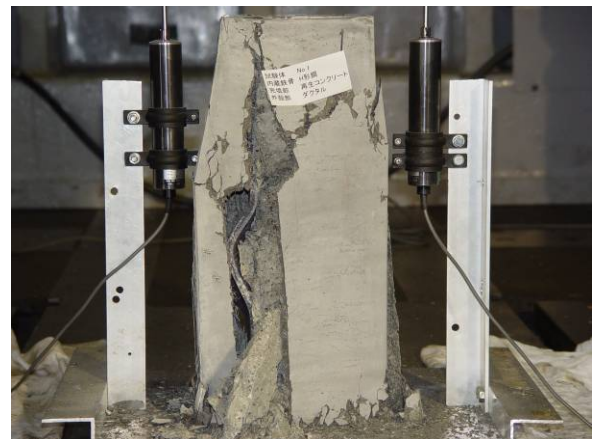
写真 7 最終破壊形状(試験体 : S-R-U)
