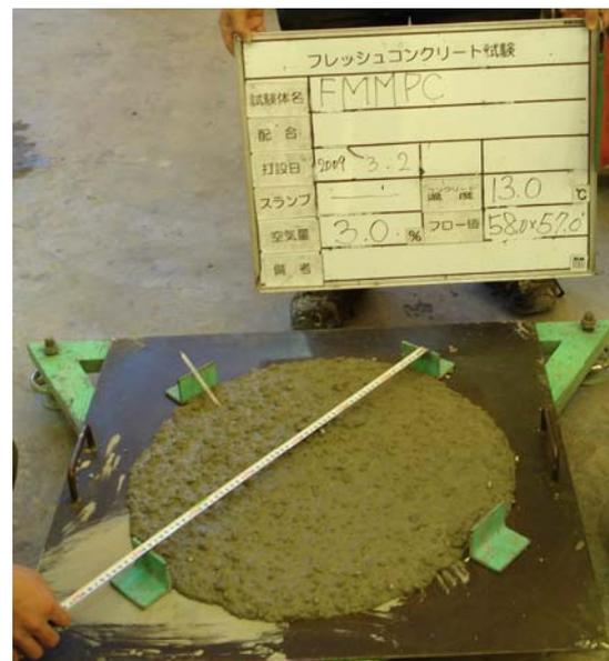
写真-1 打設時のフロー試験 (FMMPCC)
