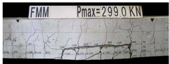
写真-6 最終破壊形状 (FMM・側面)
