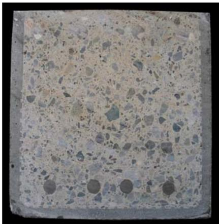
写真-8 梁切断写真
