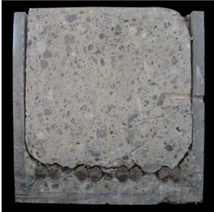
写真-7 梁切断写真
