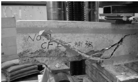
Fig.9 上下補強の破壊様相
