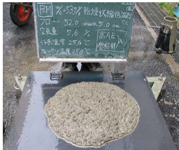
写真1 打設時のフロー試験 (FM)
