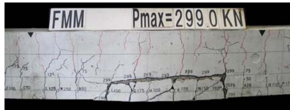
写真5 最終破壊形状 (FMM・側面)
