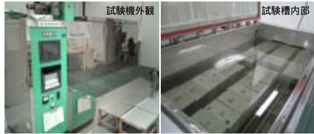
写真-1 塩水浸漬乾燥試験機
