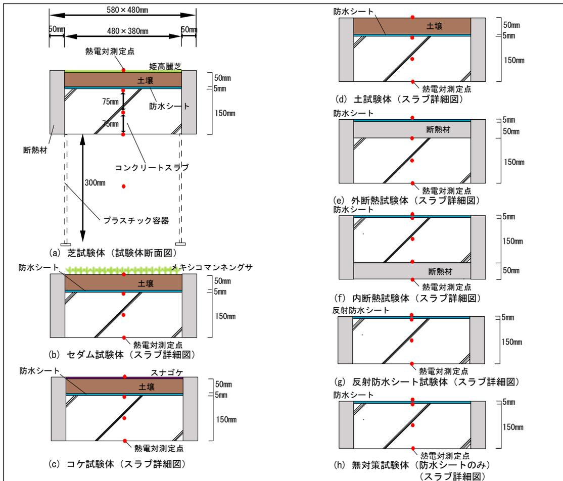
図2 試験体の概要
