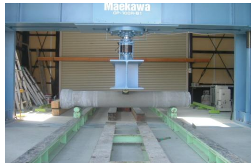
写真-6 折れ曲げ試験状況
