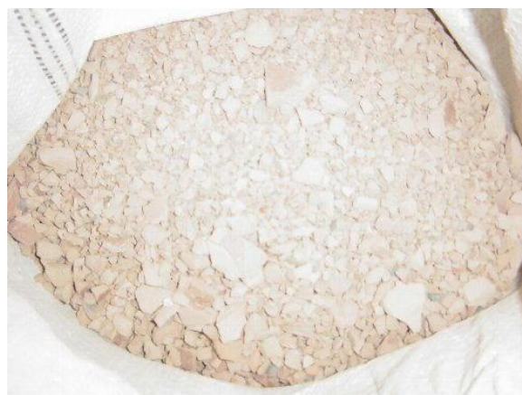
写真-3 シャモットコンクリートの練り上がり状態
