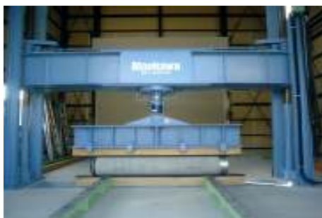
写真-5 外圧圧縮試験状況
