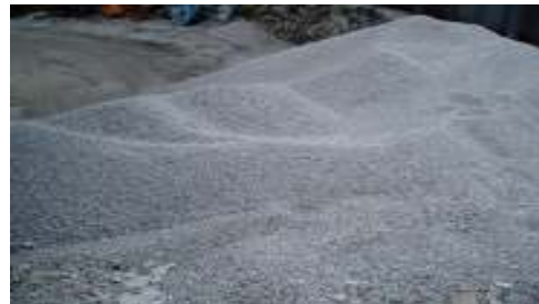
写真-2 破碎処理されたシャモット
