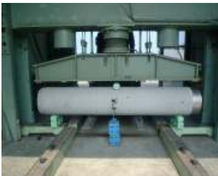
写真-7 曲げ強度試験状況
