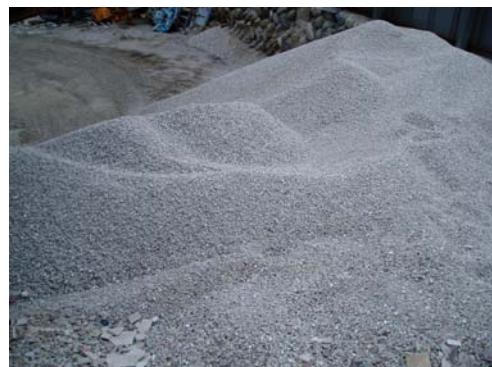
写真-2 シャモット破碎状態
