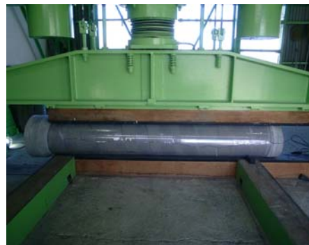
写真-4 外圧試験状況
