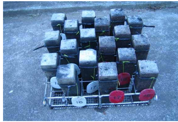
写真-7 ステンレス製籠に供試体を入れた状態
