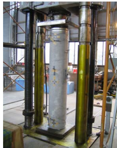
写真-5 軸方向圧縮強度試験状況
