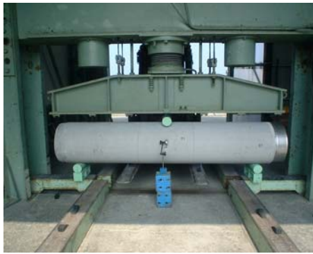
写真-6 曲げ強度試験状況
