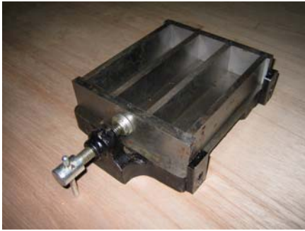
図-4 三連型枠供試体
