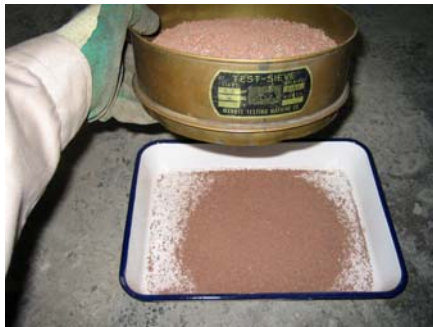
図-2 網フルイによる粒度調整状態
