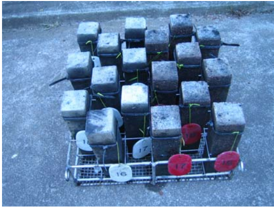
図-7 防食曝露試験
