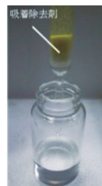
画像2 新規吸着除去剤へのCr（VI）（黄色い成分）の吸着が起こり、水が浄化されている様子
