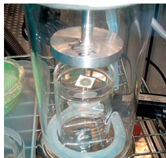
図3 拡散装置内に充填された真菌
