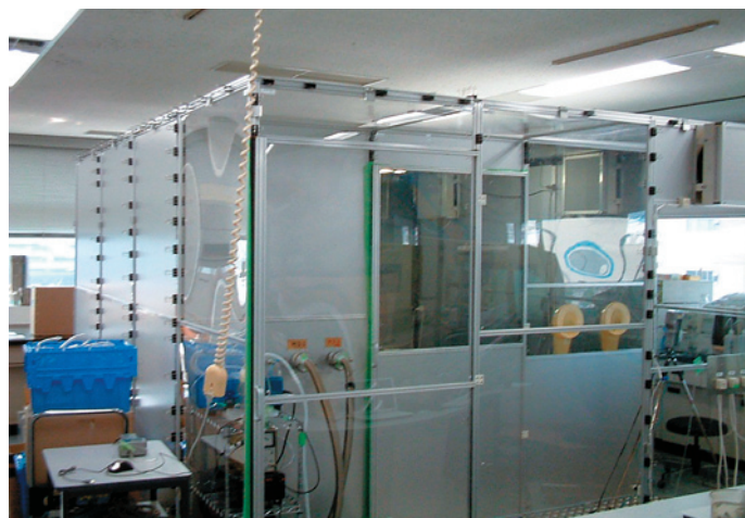
図5 組み立てパネル式クリーンブース
