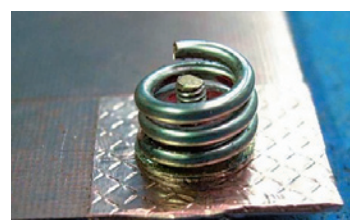
図1 小形ヘリカルアンテナの構造と形状
