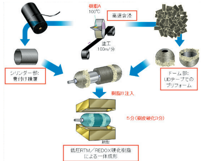
図1 高圧水素タンクの高速成形の概念図
