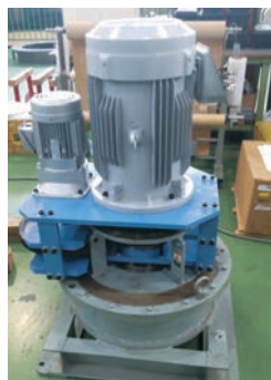
図1 遊星歯車とフライホイール発電機による10kW級エネルギー貯蔵装置
