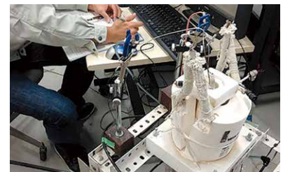
固体酸化物燃料電池の製作と性能試験（野村浩司 教授）
