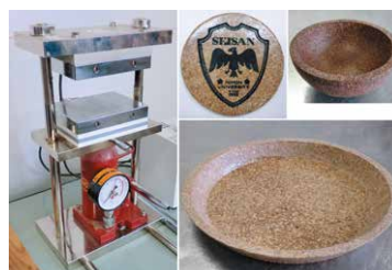
天然由来材料を用いたリサイクル複合材料成形（鈴木康介 助教）
