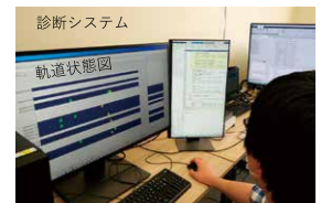
診断システム AIにより蓄積したデータを定期的に分析し、軌道の状態を診断
