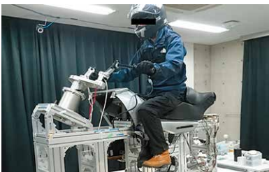
6軸動揺装置を用いた振動場におけるライダーモデル構築（渡辺淳士 助手）
