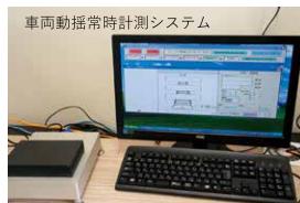
車両動揺常時計測システム 鉄道車両の動揺を遠隔で常時計測し、データを蓄積(無人計測)
