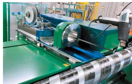
図3 CFRTPテープによるシリンダー部の成形
