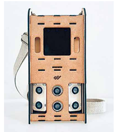
図1 携帯型障害物検知器
