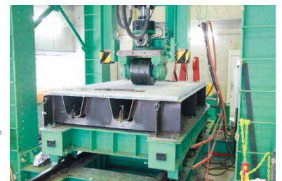
図1 輪荷重走行疲労試験機
