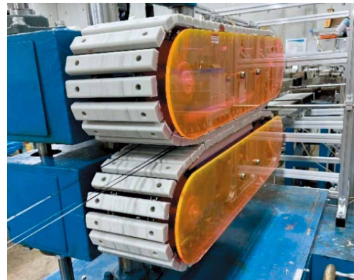
図1 連続繊維強化CFRTPテープ成形
