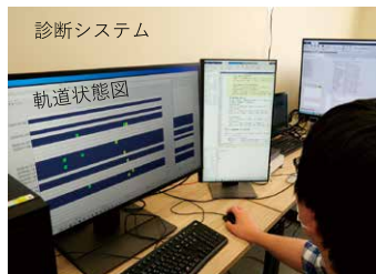
AIにより蓄積したデータを定期的に分析し、軌道の状態を診断
