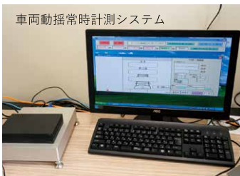
鉄道車両の動揺を遠隔で常時計測し、データを蓄積(無人計測)
