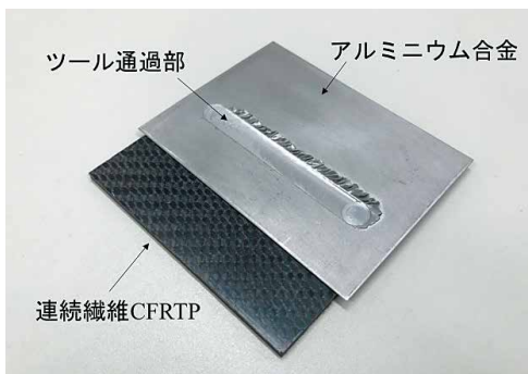
図1 摩擦シーム接合後の連続繊維CFRTPとアルミニウム合金
