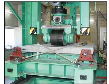
図1 輪荷重走行振動試験機
