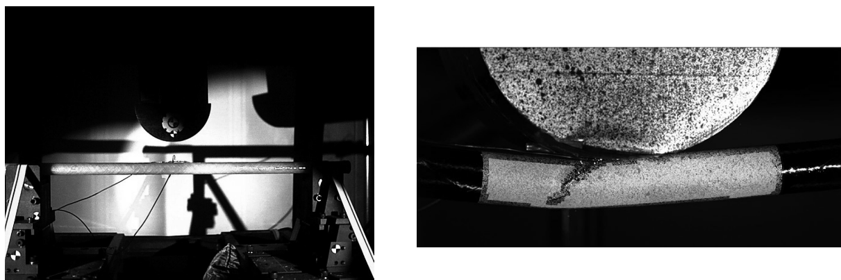
図 4 左の写真はドアインパクトビーム用 FRP 円筒の衝撃実験の様子。高さ 4.09m から 100kg の落錘子を FRP 円筒に衝突させ、その時のエネルギー吸収量を評価する。右の写真はハイスピードカメラを用いて DIC (デジタル画像相関法) で破壊モードを解析した様子。
