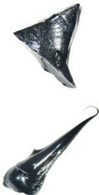
図1 劣化したアスファルト(拡大図)
