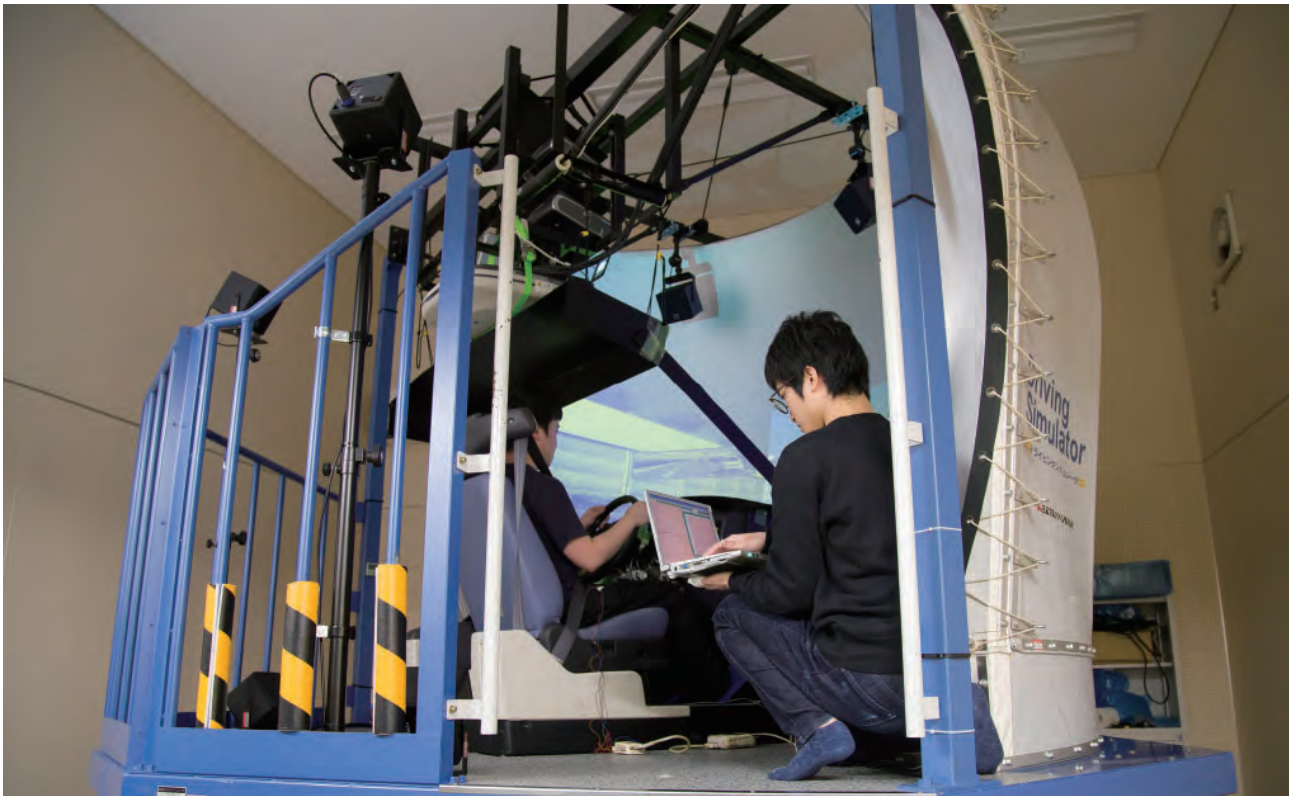
ドライビングシミュレータ上に構築した自動運転車両乗車時のドライバの脳波などの生体計測を行っている様子
