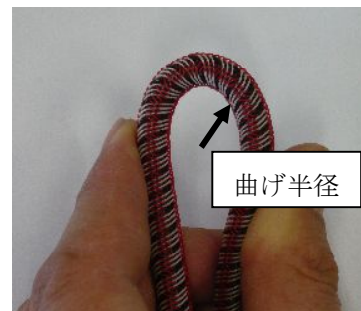
図7 漏液センサーの曲げでの誤感知検査状況
