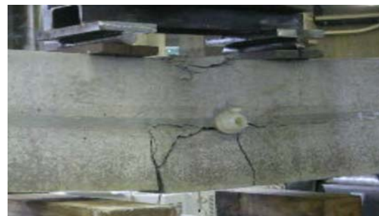
Fig.7b 中心片側補強コンクリートの破壊様相
