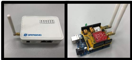
図 2 LoRa ゲートウェイと IoT デバイス
