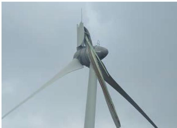
Fig. 1 本荘港風力発電所ブレード折損状況
