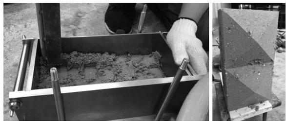
写真1 試作品とアルミ製型枠
