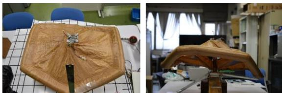
図7: 展開時に変形したと推定されるエアロシェル形状
