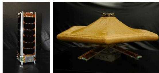
図2: EGG衛星エアロセルのフライトモデル (左: 収納状態, 右: 展開状態)
