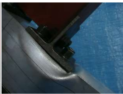
写真-1-3 H-CT 最終破壊形状
