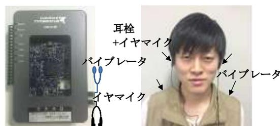
(a) FPGA モジュール (b) 振動子付きベスト
