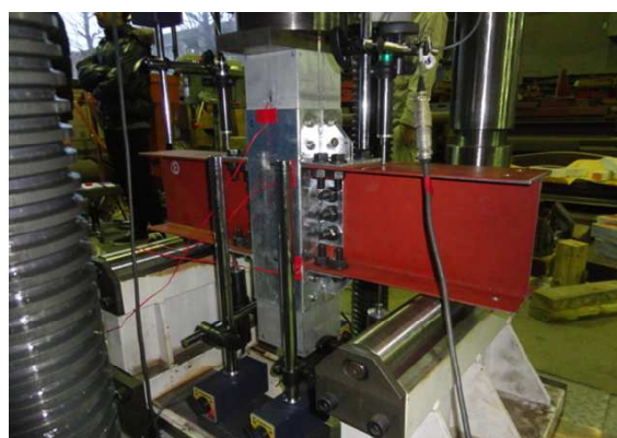
写真-1 鉛直荷重実験状況
