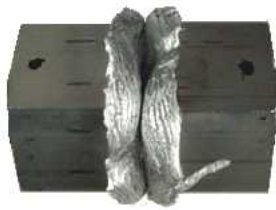
図2 6063アルミニウム合金位相制御摩擦圧接継手の外観(□25)
