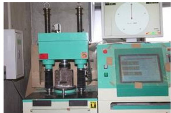
Fig.－2 一面せん断試験の状況
