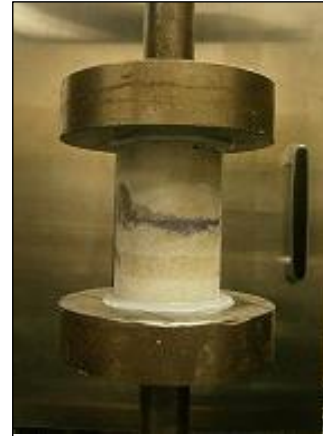
Fig.－1 直接引張り試験の状況
