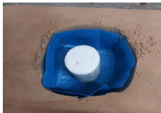
写真-9 シートと模型埋込み状況
