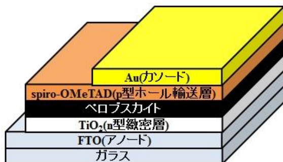
図 1 ペロブスカイト太陽電池の構造 1)
