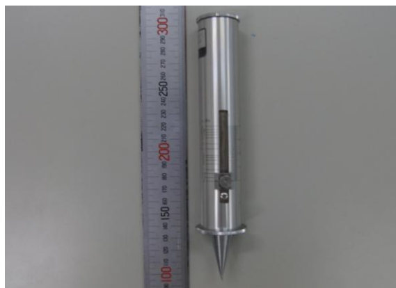
写真-2 山中式土壌硬度計
