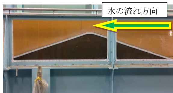
写真-1 天然ダム設置状況（側面から撮影）
