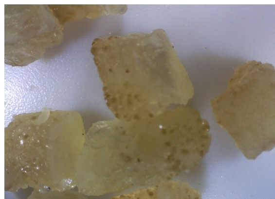
写真 - 1 アルギン酸ナトリウム・アクリルアミド法
