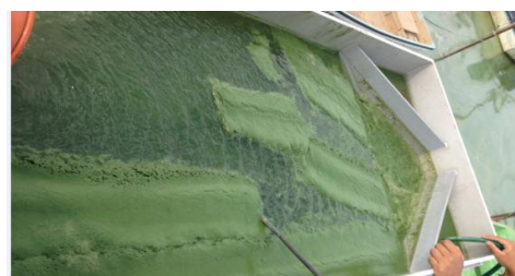
写真3 電解槽水面のスカムの回収
