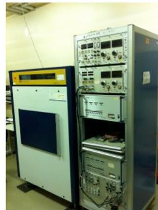
写真2. 液体シンチレーションカウンター Quantulus Model 1220
