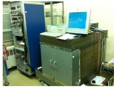
写真1 .Houtermans-Oeschger型カウンターを使用した<sup>14</sup>C年代測定装置
